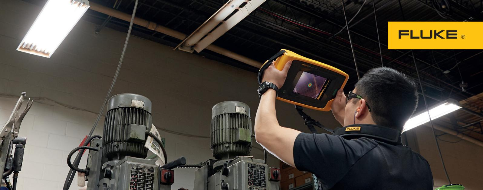
Inspecter les conduites d'air comprimé à l'aide de la caméra acoustique ultrasonore Fluke ii900
